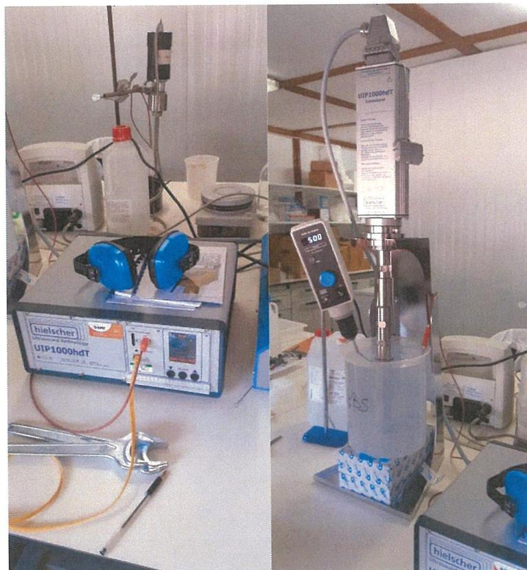
Figura 4. Detalhes do protótipo de extração por ultrassons.
